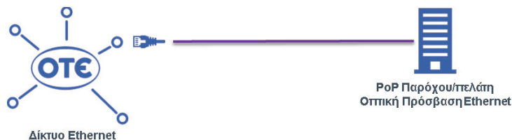
Εικόνα 3: Σχηματική απεικόνιση Οπτικής πρόσβασης Ethernet
